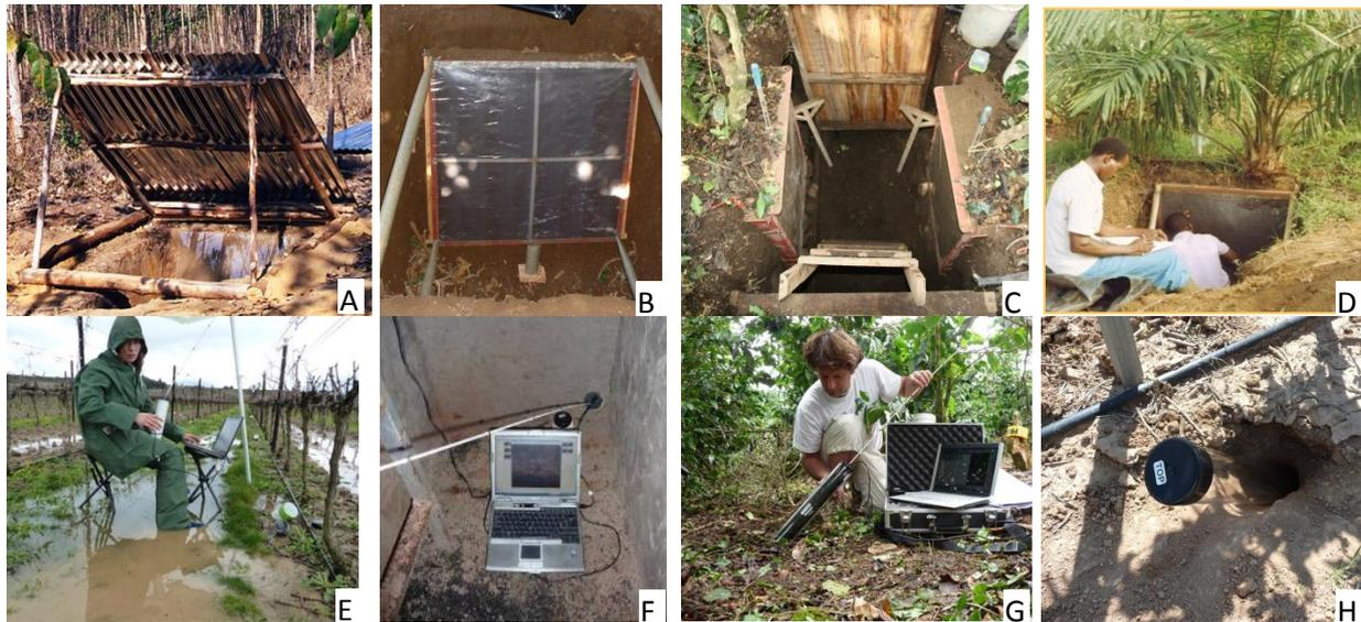
Figure 24. Rhizotrons installés dans une plantation d'eucalyptus au Congo (A), de mangroier à la Réunion (B), de caféier au Costa Rica (C) et de palmier à huile en Côte d'Ivoire (D). Minirhizotrons installés sur vigne en France (E), sur eucalyptus au fond d'une fosse de 7 m de profondeur au Brésil (F), sur caféier au Costa Rica (G) et détail du tube avant installation définitive (H).
