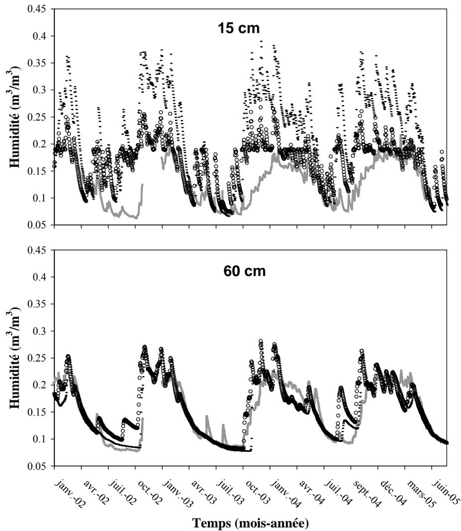
**Figure 24.** Comparaison entre les mesures et les simulations de l'humidité moyenne du sol de la parcelle de Douglas du site expérimental de Breuil. Simulations réalisées en utilisant les propriétés hydrodynamiques du sol prédites par la FPT ROSETTA avec prise en compte des deux mesures d'humidité. Trait gris : mesures TDR ; petits rectangles noirs : sans écoulements préférentiels ; cercles : avec prise en compte des écoulements préférentiels.
