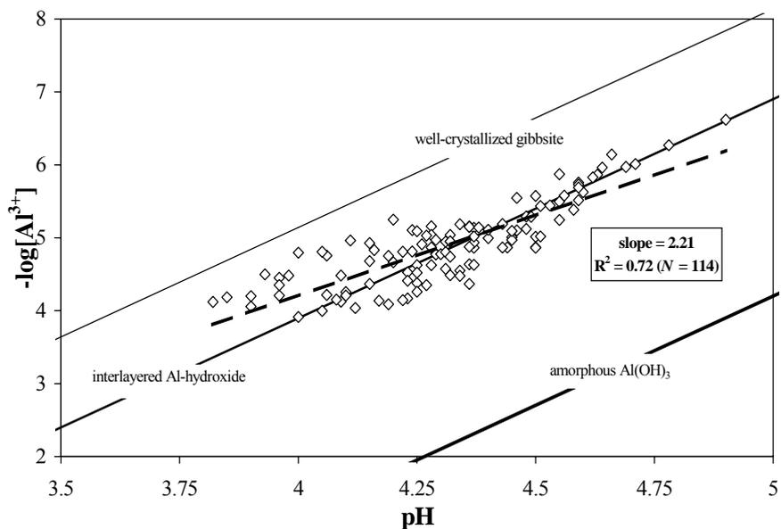
**Figure 10.** Diagramme d'activité dans le système Al-H (Gérard et al., 2003). Calculs réalisées à l'aide du modèle Phreeqc 2 (Parkhurst and Appelo, 1999), en utilisant le formalisme de ligands organiques équivalents pour simuler la complexation organo-métallique. Solutions capillaires fortement liées du site de Vauxrenard (Rhône).
