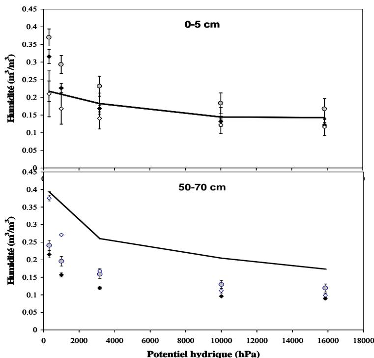
**Figure 22.** Comparaison entre les mesures et les prédictions de la courbe humidité-potentiel hydrique. Site de Breuil, parcelle de Douglas, exemple à 0-5 cm et 50-70 cm. Trait noir : mesures ; cercles gris : prédictions par la FPT de Wösten et al. (1999) ; losanges noirs : prédictions par la FPT ROSETTA sans les deux mesures d'humidité ; losanges blancs : prédictions par ROSETTA en utilisant les deux mesures d'humidité.
