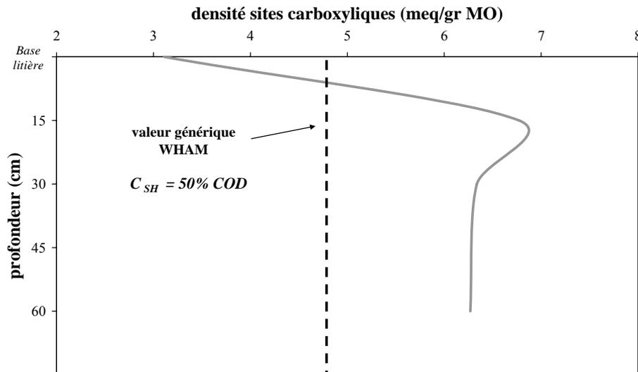
**Figure 5.** Variations avec la profondeur du sol de la densité des sites carboxyliques des SH estimées par calibration du modèle WHAM-VI. Dans cet exemple, la concentration des substances humiques (assimilés à des acides fulviques) a été fixée à 50% du COD et les calculs réalisés dans des solutions du site de Vauxrenard (Rhône) collectées par des plaques lysimétriques.
