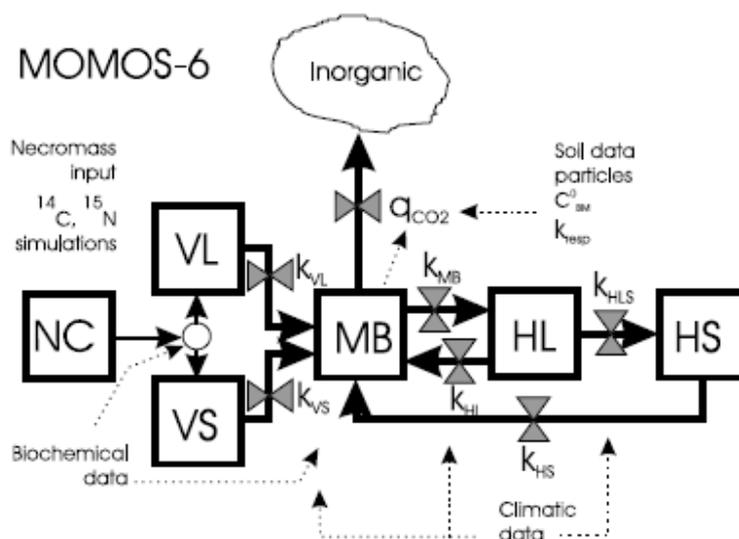
**Figure 36.** Modèle conceptuel utilisé dans le modèle MOMOS-6 pour simuler le cycle de C et de N dans les écosystèmes terrestres (Pansu et al., 2004). NC : nécromasse ; VL : nécromasse labile ; VS = nécromasse stable ; MB : biomasse microbienne ; HL = MO humifiée labile ; HS : MO humifiée stable. Les variables k sont en fait les constantes des lois cinétiques d'ordre 1 contrôlant les flux entre les différents compartiments.  $q_{CO_2}$  est le flux de  $CO_2$  respiré par les microorganismes.
