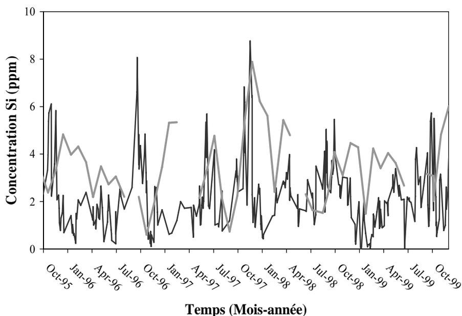
**Figure 17.** Concentration moyenne en silice mesurée dans les solutions gravitaires collectées à 15 cm de profondeur (trait gris) et dans les solutions collectées sous la litière (trait noir). Site de Vauxrenard.
