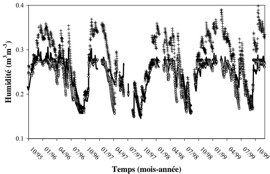
**Figure 21.** Humidité moyenne journalière du sol de Vauxrenard en fonction du temps. Exemple à 30 cm de profondeur. Trait noir : mesure TDR ; croix : modélisation réalisée en tenant compte des prédictions de la FTP ROSETTA ; cercles gris : modélisation avec prise en compte des écoulements préférentiels.
