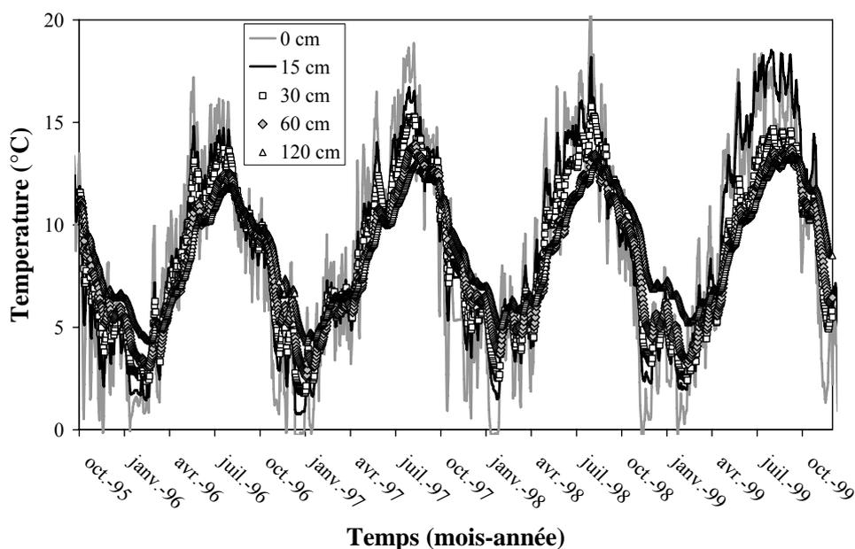
**Figure 26.** Températures mesurées à différentes profondeurs du sol du site de Vauxrenard, considérées dans le modèle MIN3P afin de simuler la concentration de Si mesurées dans les solutions capillaires faiblement liées.
