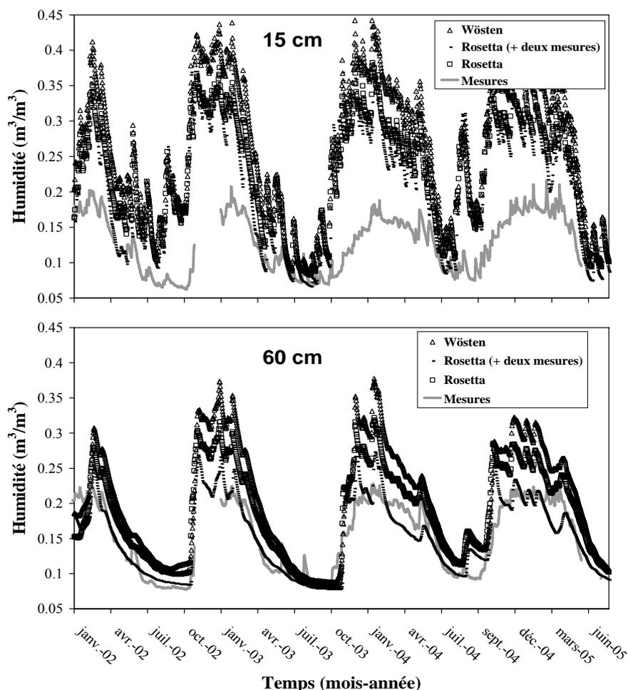
**Figure 23.** Comparaison entre les mesures et les simulations de l'humidité moyenne du sol de la parcelle de Douglas du site expérimental de Breuil. Simulations réalisées en considérant les propriétés hydrodynamiques du sol prédites à l'aide de la FPT ROSETTA, avec et sans prise en compte des deux mesures d'humidité, et de la FPT de Wösten et al. (1999).
