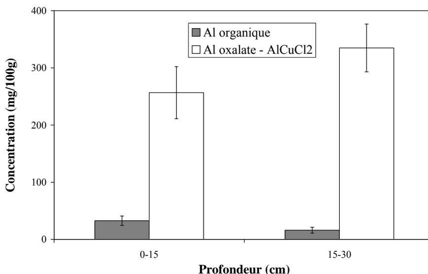
**Figure 14.** Concentration en aluminium adsorbé à la MOS et différence entre Al extrait par oxalate et Al extrait par chlorure de cuivre, correspondant à la concentration d'Al sous forme d'hydroxyde amorphe et faiblement cristallisé. Sol du peuplement de Douglas, site de Breuil (Baton, 2004)
