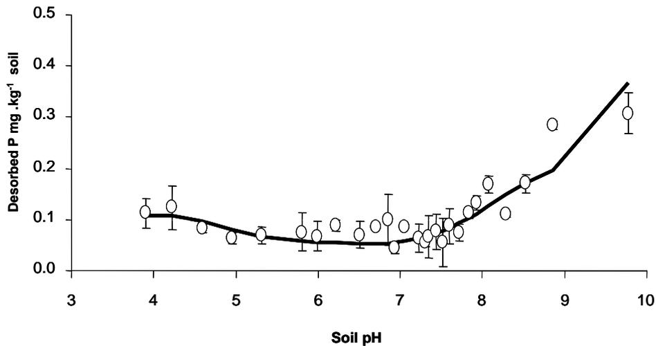
**Figure 33.** Comparaison mesure-modélisation des concentrations en P inorganique extraites par  $\text{CaCl}_2$  dans l'horizon de surface d'un Cambisol (0-20 cm) (fersialitique, pH neutre) (Devau, 2007). Les symboles blancs correspondent aux mesures, le trait continu à la modélisation.
