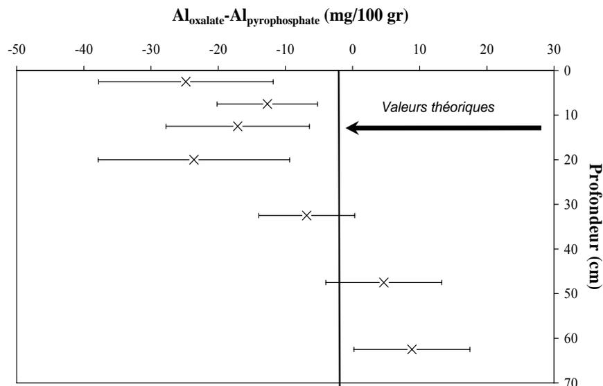
**Figure 13.** Evolution de la différence entre aluminium extrait par oxalate et aluminium extrait par pyrophosphate (Forêt, 2003). Données acquises dans le sol du peuplement de Douglas du site de Breuil.
