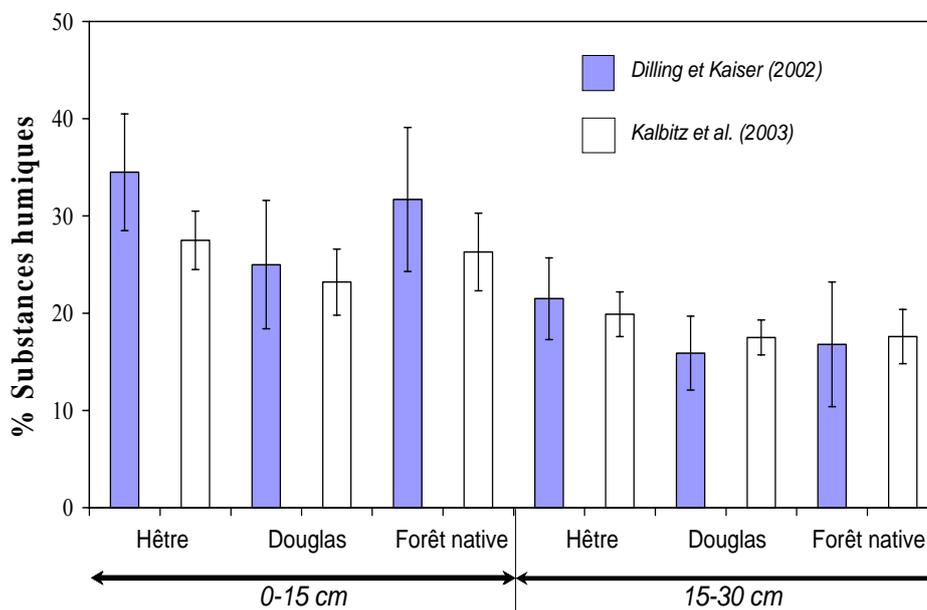
**Figure 6.** Estimations de la concentration en substances humiques réalisées à partir des mesures d'absorbance UV/visible et des fonctions proposées par Dilling et Kaiser (2002) et par Kalbitz et al. (2003). Résultats des solutions capillaires fortement liées du site expérimental de Breuil (Jaffrain, 2007). Echantillons collectés à deux intervalles de profondeur (0-15 cm et 15-30 cm) et dans trois parcelles (plantations de hêtre et de Douglas, et parcelle de forêt native).
