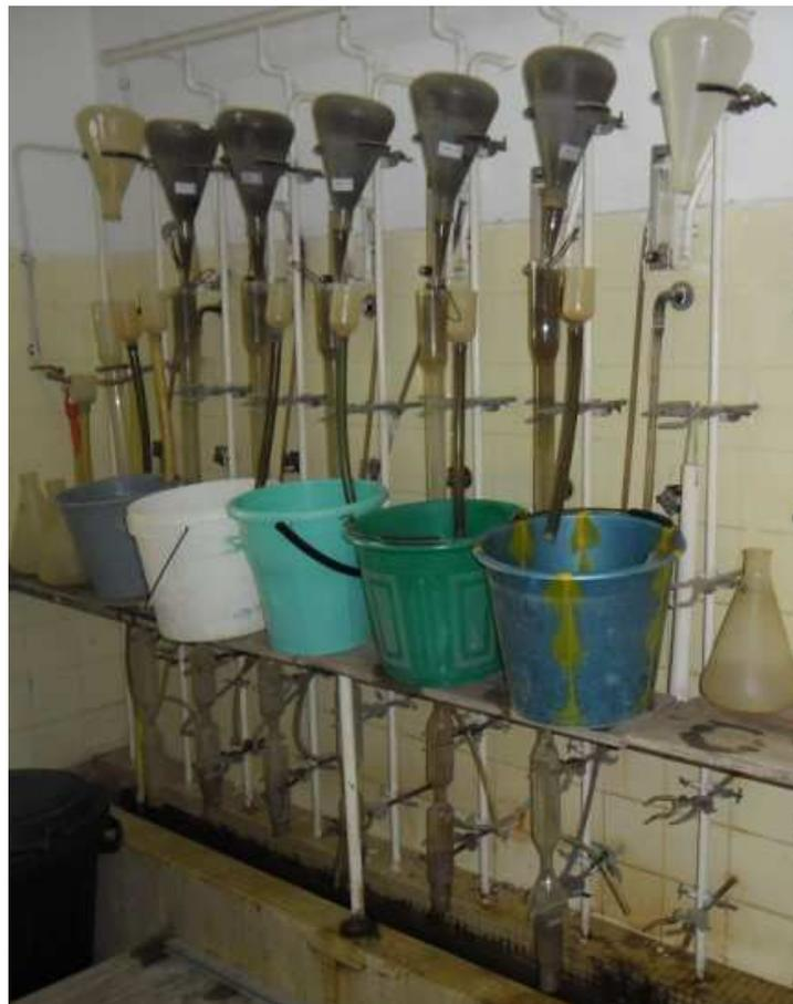
**Figure 29** : Dispositif de Seinhorst permettant l'extraction des nématodes du sol (©S.Diakhaté, IRD).
