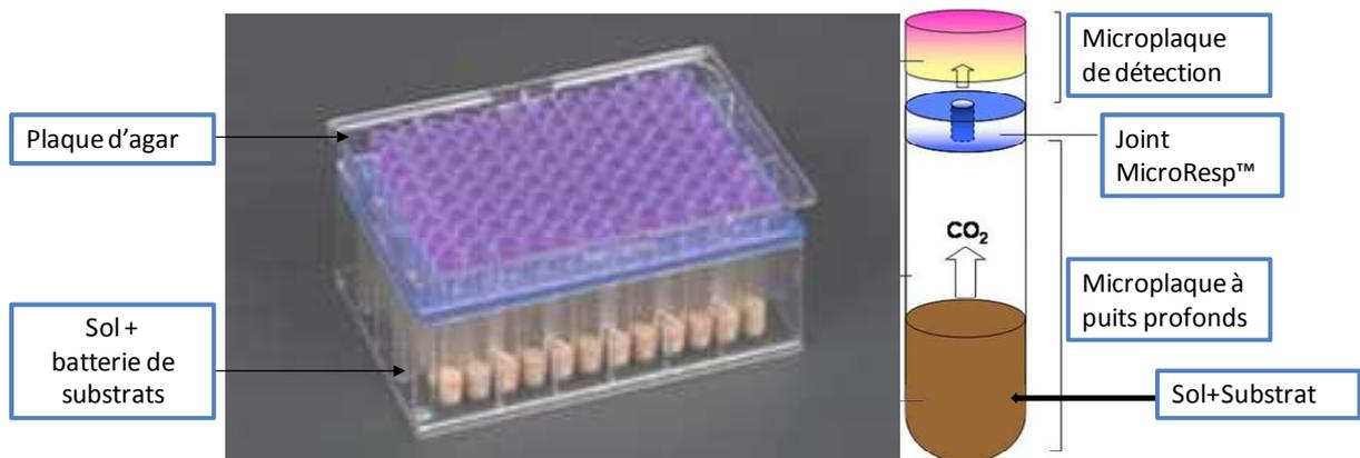
**Figure 20** : Principe de la technique MicroResp™ (crédit photo : [www.MicroResp.com](http://www.MicroResp.com))
